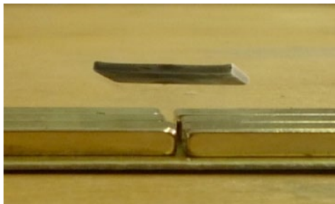
Un superconductor d'alta temperatura levita sobre imants de neodimi, a causa de l'efecte Meissner
